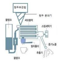
본 문서는 2016년 건국대학교의 소프트웨어공학 개론 강의의 실습과제를 설명한다. 실습 과제는 Coffee machine을 소프트웨어로 구성된 가상의 시스템으로 구현함을 그 목적으로 한다. Coffee machine은 위의 설계도와 같이 원두 보관함과 원두 분쇄기, 물 탱크, 물을 데우는 스팀 노즐(증기 노즐), 커피가루가 담긴 Filter Holder로 이루어져 있 다. 우리는 이 CM을 이용해 커피를 만드는 것이 목적이고, 그 과정에서 뜨거운 커피를 원한다면 노즐을 데워 물을 뜨겁게 하거나, 원두를 갈고 싶다면 분쇄기를 이용하는 등 기계를 이용할 수 있다. 물, 원두 등의 재료와 Filter Holder, CUP 등 커피를 추출하는데 확인해야 하는 요소들은 센서를 통해 확인할 수 있고, 위생적인 커피 추출을 위해 노 즐을 청소하는 기능도 포함되어 있다. 이 Coffee machine은 사용자가 전원을 끄길 원 할 때는 언제든 종료할 수 있다.
